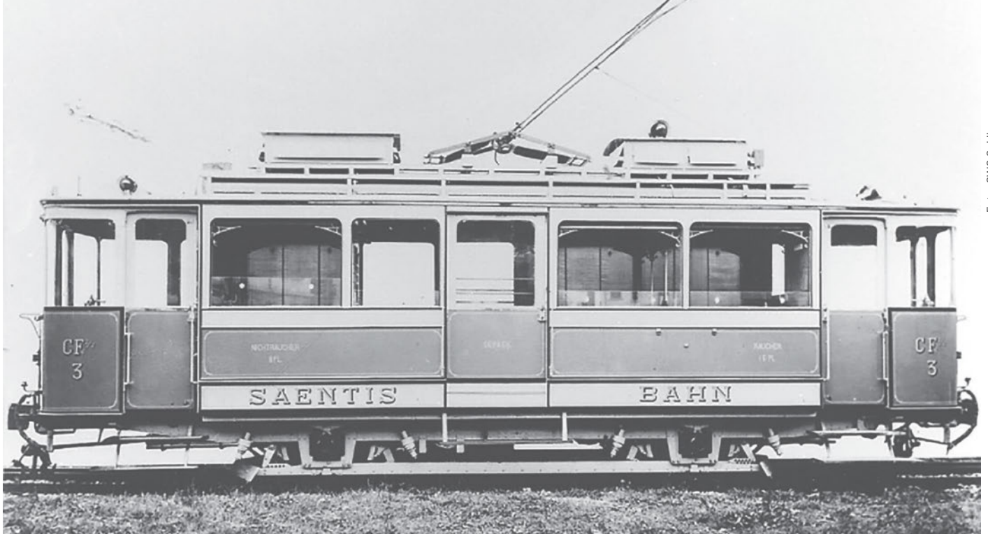
Bild 7: Werkfoto des CFe 3 der «Saentisbahn» von 1912, aus welchem später der heutige Te 2/2 Nr. 49 konstruiert wurde.
